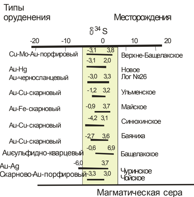
Рис. 1. Значения тяжёлого изотопа серы в сульфиде золоторудных месторождений и проявлений Горного Алтая
